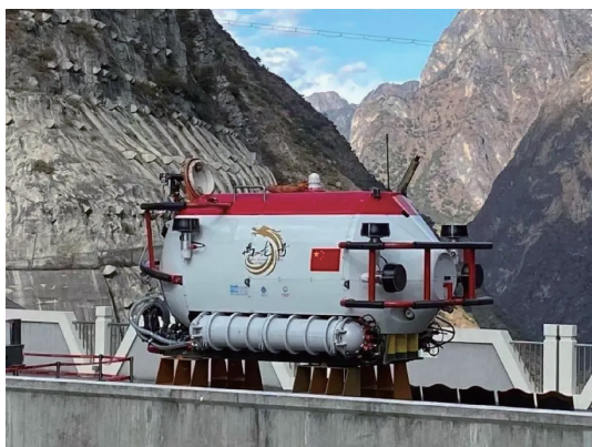
图 40 禹龙号大坝深水检测载人潜水器
